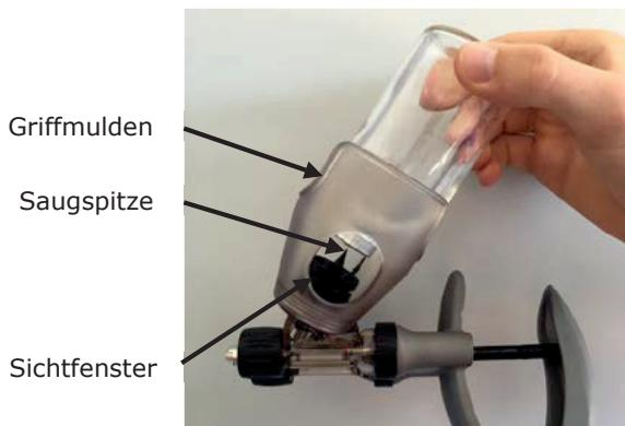
Zum späteren Entfernen ist die Flasche an den seitlichen Griffmulden nach oben abzuziehen.
