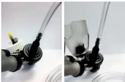
Bei der gleichzeitigen Verwendung von Flaschen- und Schlauchansatz empfiehlt es sich, den Zylinder mit dem Schlauchansatz vor dem Zylinder mit dem Flaschenaufsatzt teilweise zu befüllen. Das verhindert die Verschwendungen von Impfstoff über den Zylinder mit dem Flaschenaufsatzt.
