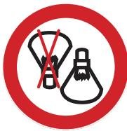
(DE) Installation ausschließlich in vertikaler Ausrichtung nach unten
